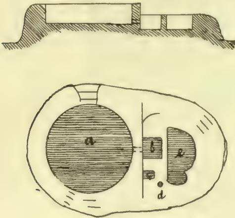
Abb. 314: Zisternenanlage Nr. 806, Grundriß und Durchschnitt.
